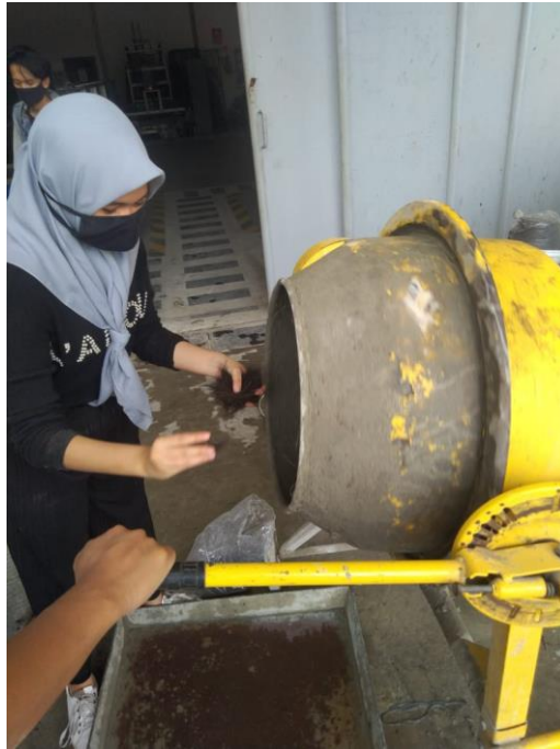
Gambar L7: Dokumentasi proses pencampuran serat ijuk
