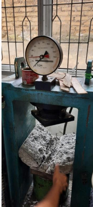
Gambar L9: Dokumentasi pengujian kuat tarik belah beton
