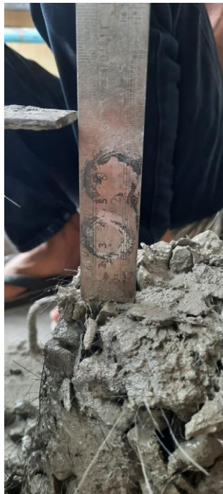
Gambar L5: Dokumentasi tes nilai slump
