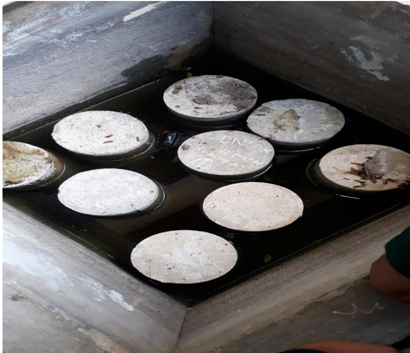
Gambar L7: Dokumentasi proses perawatan beton menggunakan rendaman air tawar
