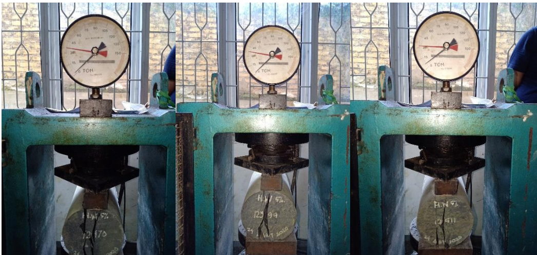
Gambar L-28: Pengujian Kuat Tarik Belah BB5
