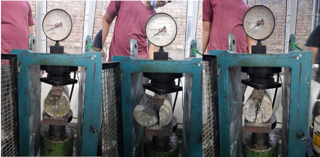
Gambar L-27: Pengujian Kuat Tarik Belah BB0
