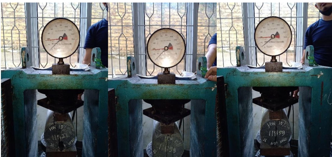
Gambar L-29: Pengujian Kuat Tarik Belah BB10
