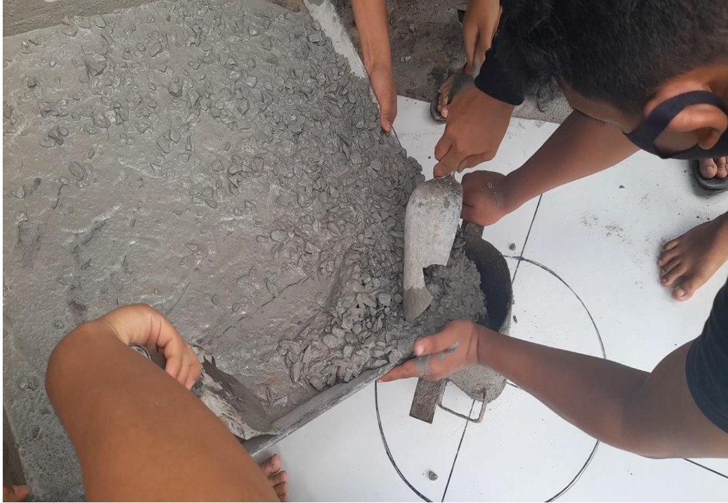
Gambar L-19: Proses Pengujian Slump Flow
