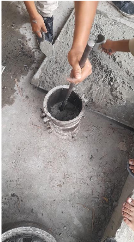
Gambar L-21: Perojokan Adukan Beton di Cetakan
