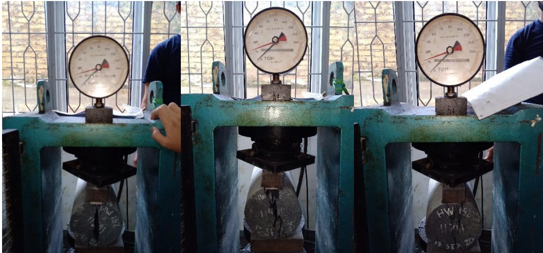
Gambar L-30: Pengujian Kuat Tarik Belah BB15
