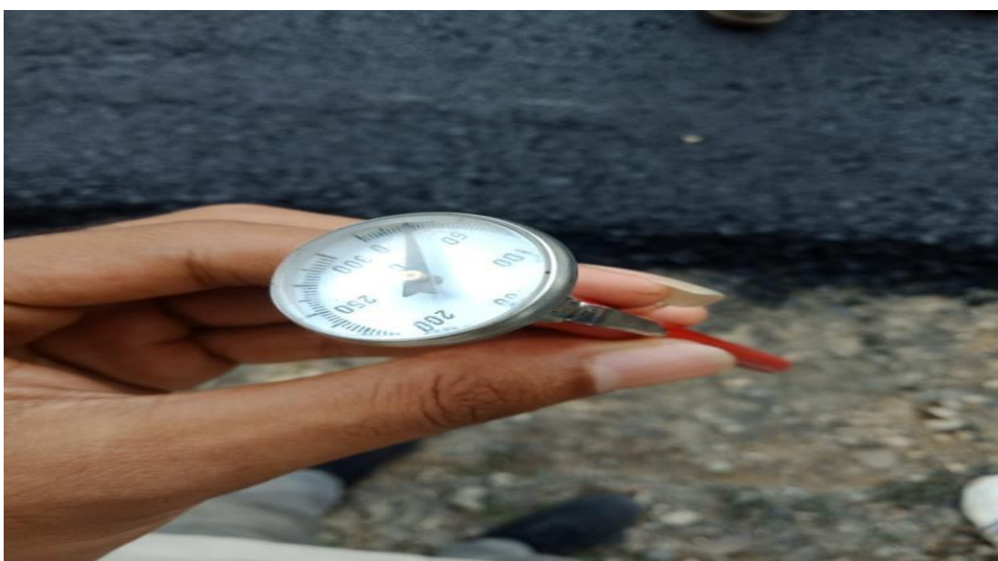
Gambar 10 : Thermometer untuk mengecek suhu aspal
