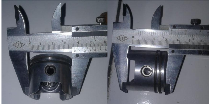
Gambar 3.4 pengukuran piston tiger 30 cc dengan jangka sorong
