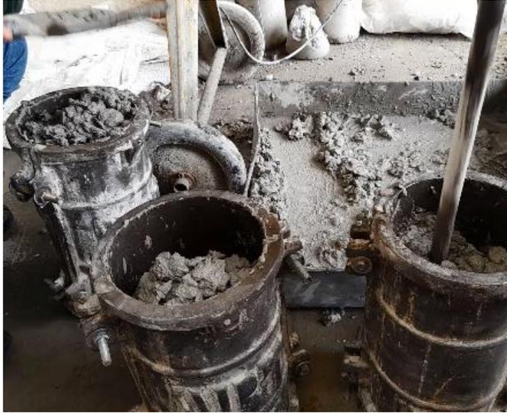
Gambar L-23: Perojokan Adukan Beton dicetakan.
