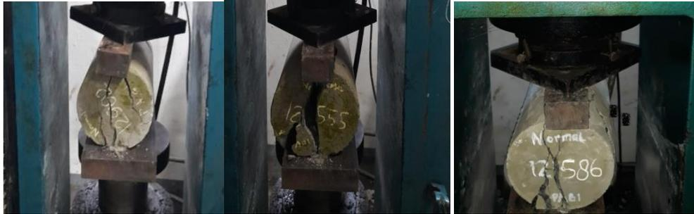
Gambar L-29: Pengujian Kuat Tarik Belah Beton Normal.
