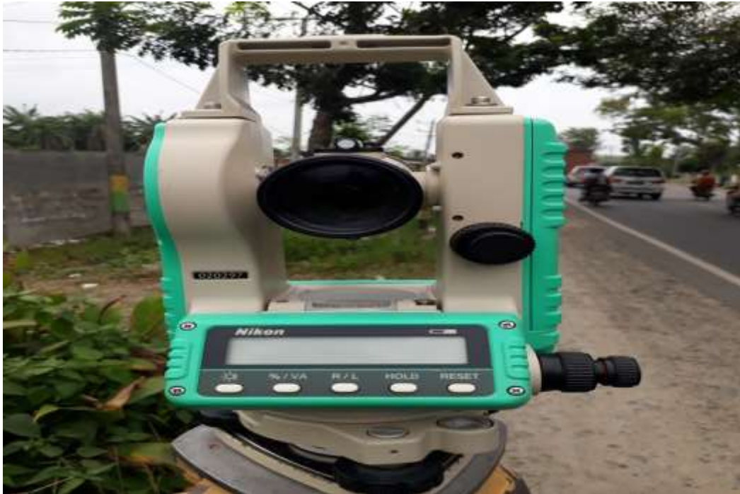
Gambar L.3: Theadolit Nivel System
