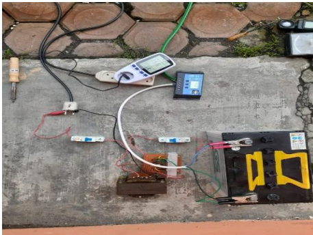
Gambar 4.2. pengujian inverter terhadap beban
