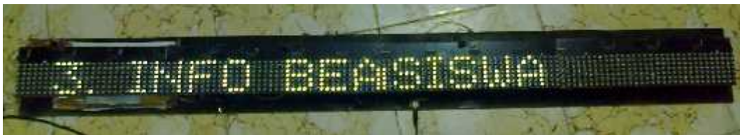
Gambar 4.7 Hasil display pembacaan kode biner sandi ASCII kebentuk teks alphanumeric .
