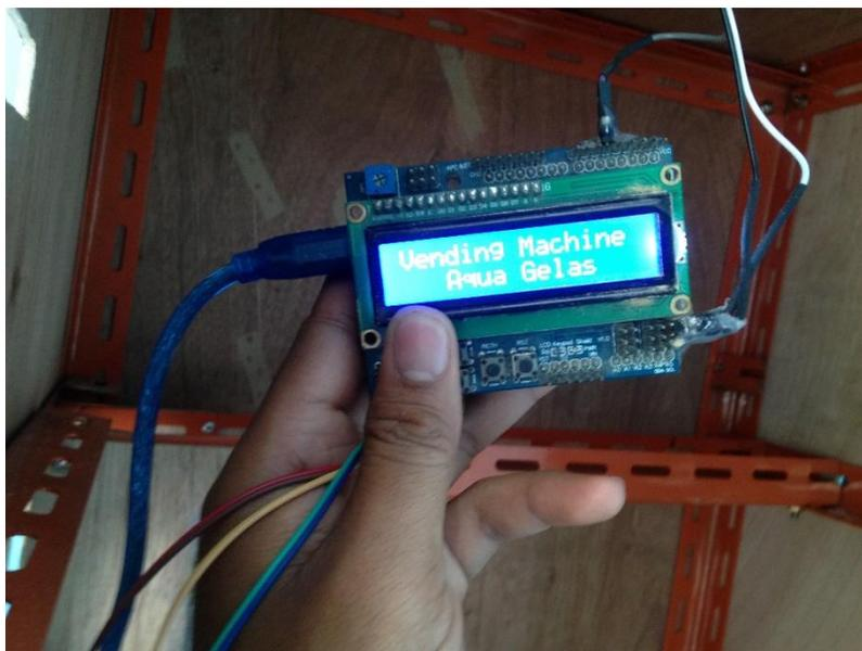
**Gambar 4.18 Foto Arduino dengan Modul LCD**
