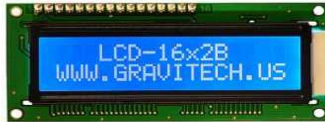
Gambar 2.6 Bentuk Fisik LCD 16x2
