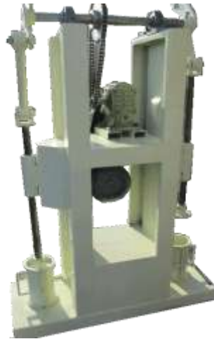
Gambar 2.4 Mesin Press Menggunakan Tenaga Motor Listrik dan Gearbox
