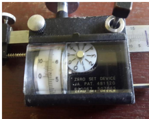
Mengukur sampel luas daun tanaman menggunakan plannimeter
