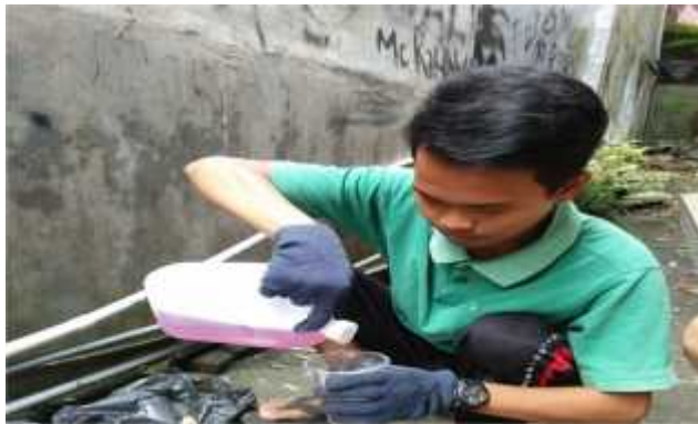
Gambar. 3.27 Menuang resin ke dalam wadah
