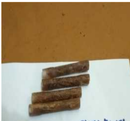
Gambar 4.2 Spesimen sesudah dibubut
