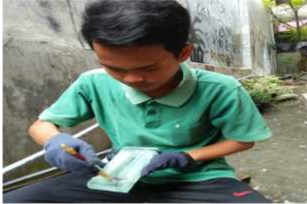
Gambar. 3.26 Mengoleskan mirror glaze pada bagian cetakan spesimen
