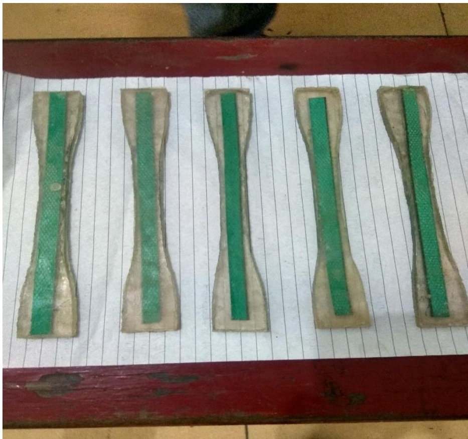
Gambar 3.11. Hasil cetakan komposit serat tali packing
