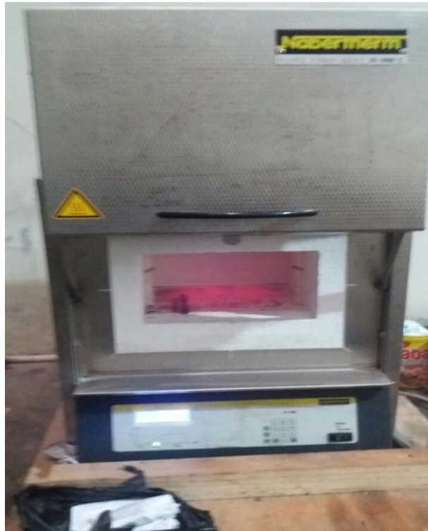
Gambar 3.5. Spesimen di dalam tungku dan penyetingannya
