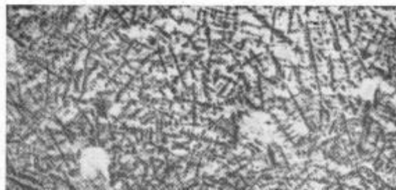
Gambar 2.1 Struktur Mikro Baja Karbon Ultra Rendah. Seluruhnya Ferrite.
