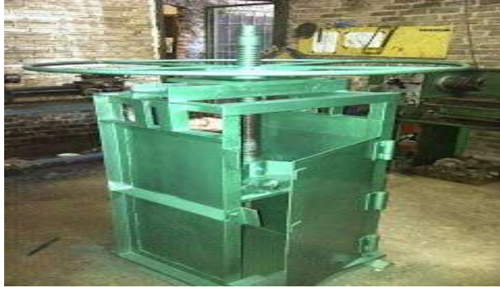
Gambar 2.3 Mesin press/kempa menggunakan tenaga manual
