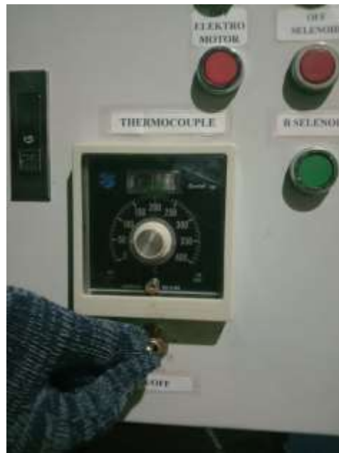
Gambar 4.3 Menghidupkan saklar on Elektro Motor
