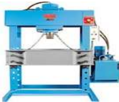
Gambar 2.2 Mesin kempa menggunakan tenaga hidrolik
