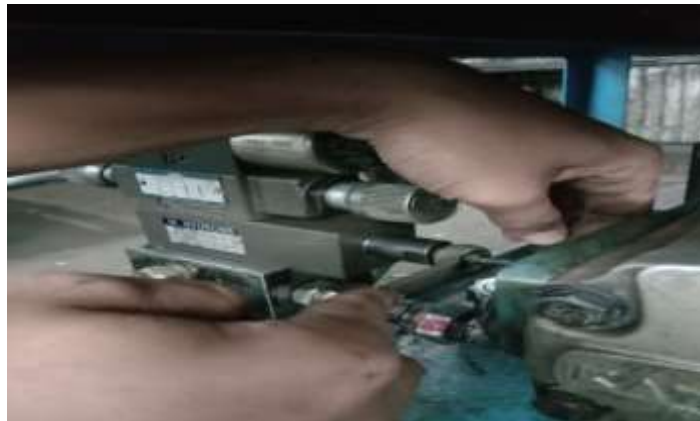
Gambar 4.6 Mengatur modular valve
