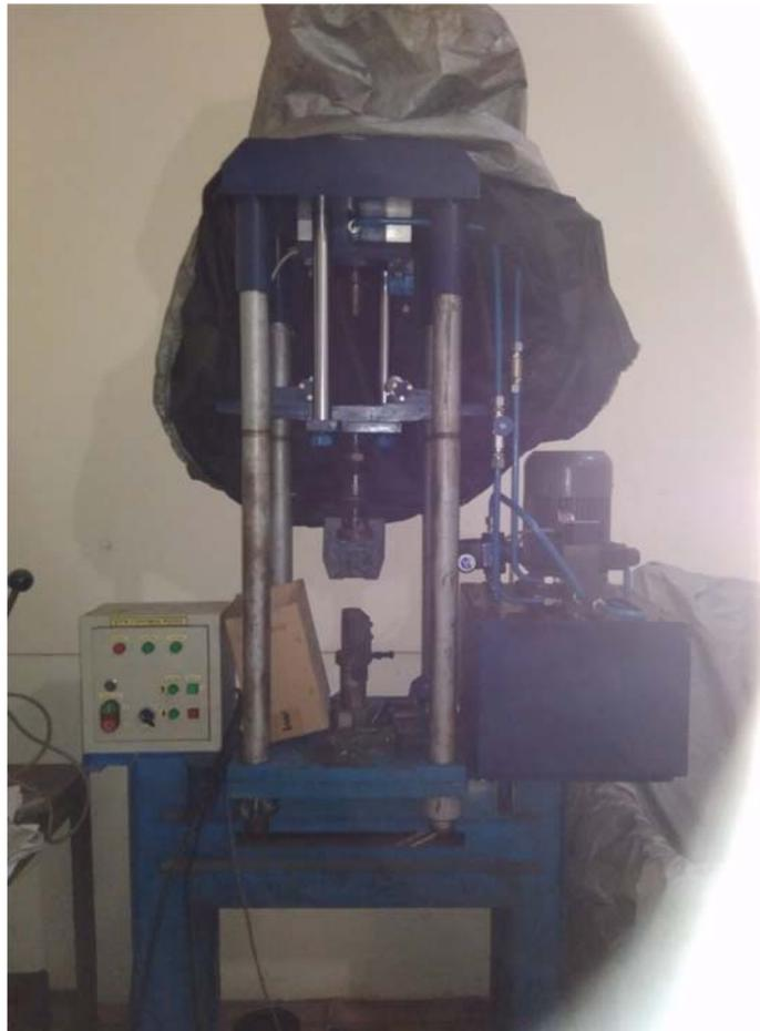
Gambar 3.3: Mesin uji tarik
