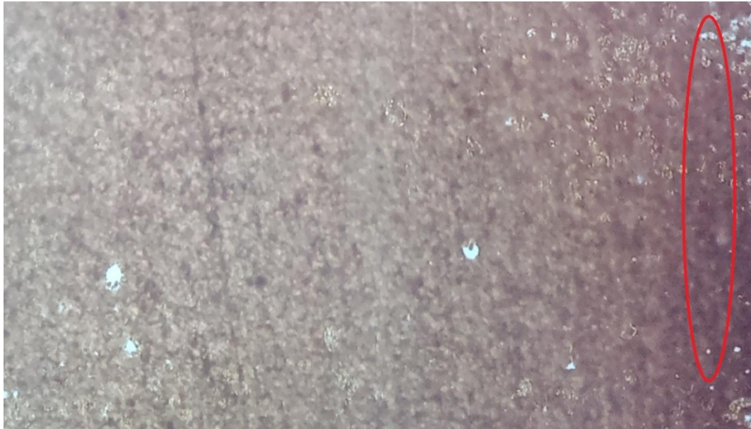
Gambar 4.2. Foto Hasil Pengujian Mikro Struktur Setelah di Karburasi Dengan 100 x Pembesaran
