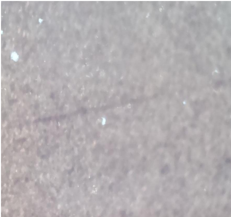
Gambar 4.1 Foto Hasil Pengujian Struktur Mikro Sebelum di Karburisasi Dengan 100x Pembesaran
