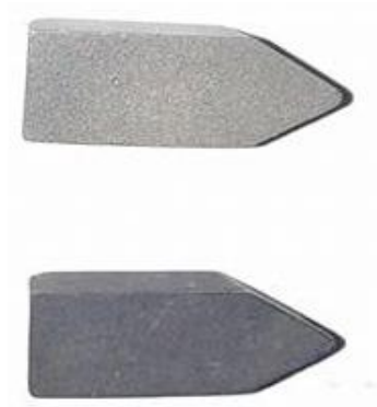
Gambar 3.3 Pahat Bubut Karbida Sebelum dan Sesudah di Karburasi
