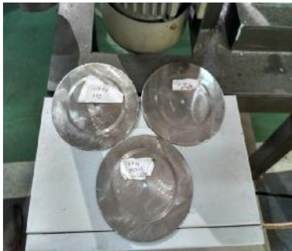
Gambar 4.1 Spesimen Uji Gesek Dari Bahan Paduan Nikel
