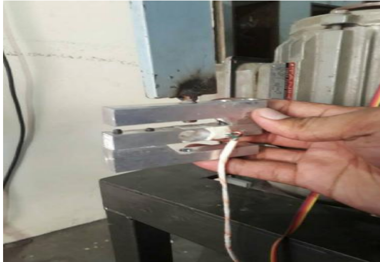
Gambar. 3.12 Pemasangan Load Cell
