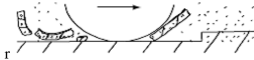
Gambar 2.6 Corrosive wear karena pengelupasan yang terjadi pada lapisan yang rapuh (Almen J.O 1950)
