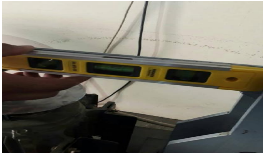
Gambar 3.15 Meratakan Benda kerja
