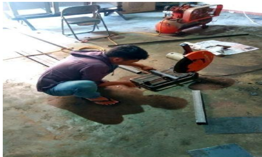
Gambar 3. 24 Pemotongan UNP dan besi plat
