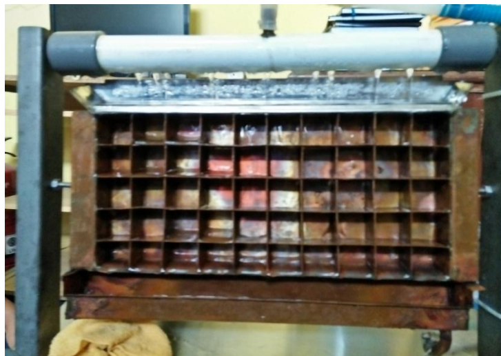
Gambar 4.5 Cetakan Vertikal dengan Te 9,8 0 C dan Tc 30,4 0 C
