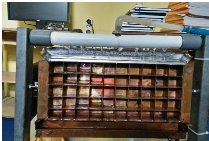
Gambar 4.9 Cetakan Vertikal dengan Te 8,6 0 C dan Tc 29,6 0 C
