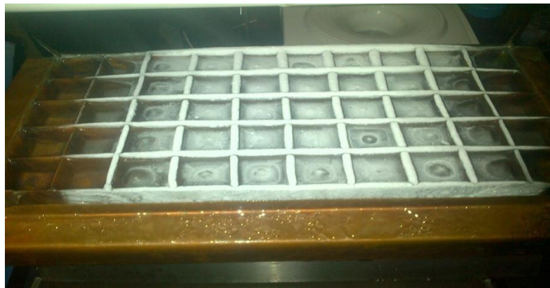
Gambar 4.29 Cetakan Horizontal dengan T_e -10^{\circ}\text{C} dan T_c 37,3^{\circ}\text{C}
