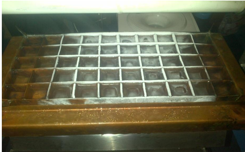
Gambar 4.27 Cetakan Horizontal dengan T_e -9,8^{\circ}\text{C} dan T_c 35,3^{\circ}\text{C}
