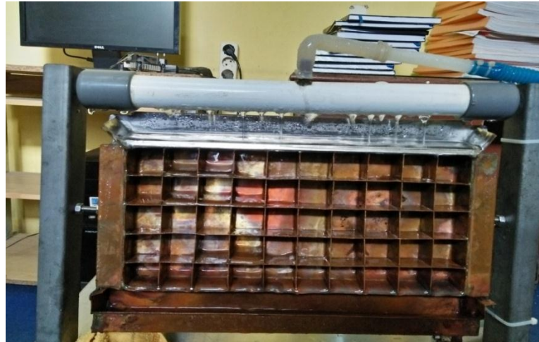
Gambar 4.3. Cetakan Vertical dengan T_e 9,8^{\circ}\text{C} dan T_c 30,8^{\circ}\text{C}
