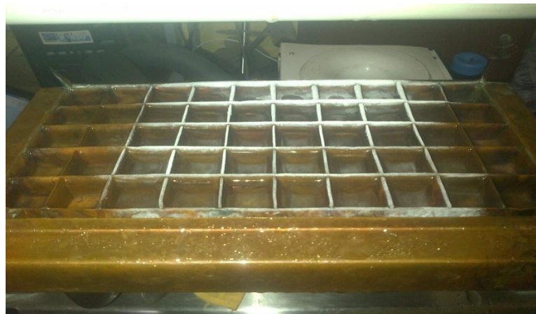
Gambar 4.25 Cetakan Horizontal T_e -5,3^{\circ}\text{C} dan T_c 38^{\circ}\text{C}
