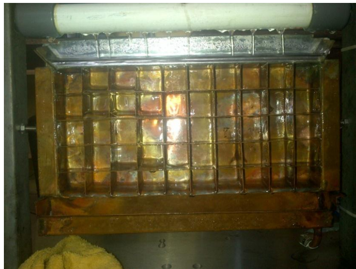
Gambar 4.13 Cetakan Vertikal dengan Te 3,7 0 C dan Tc 33,6 0 C
