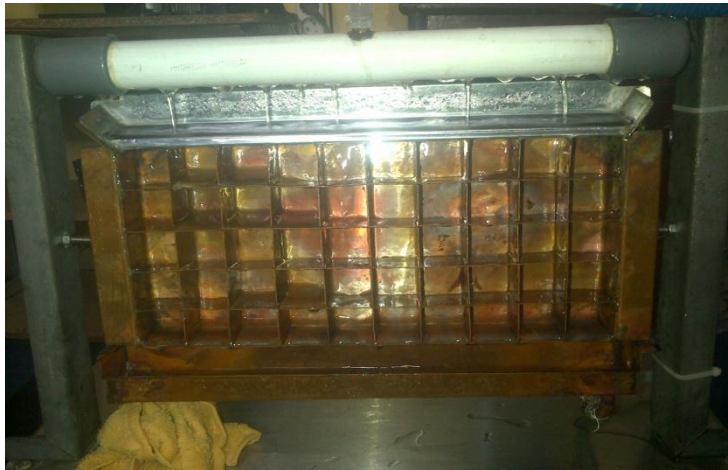
Gambar 4.7 Cetakan Vertikal dengan T_e 8,8 0 C dan T_c 29,2 0 C
