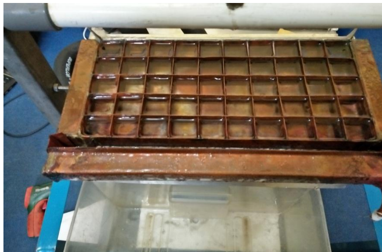
Gambar 4.21 Cetakan Horizontal dengan T_e -1,1^{\circ}\text{C} dan T_c 36,2^{\circ}\text{C}
