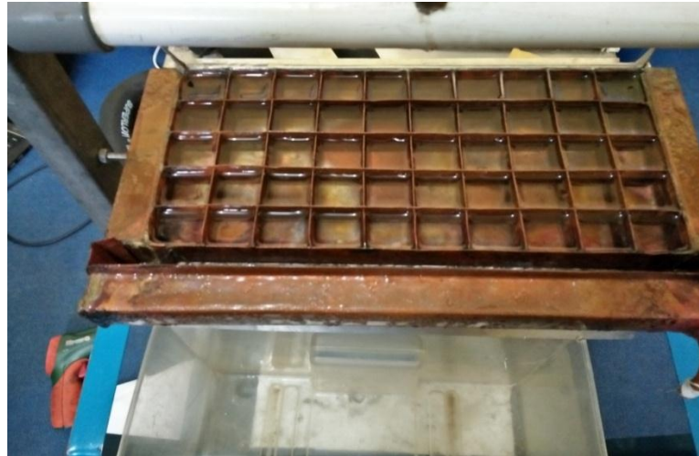
Gambar 4.19 Cetakan Horizontal dengan T_e -0,9^{\circ}\text{C} dan T_c 34,9^{\circ}\text{C}
