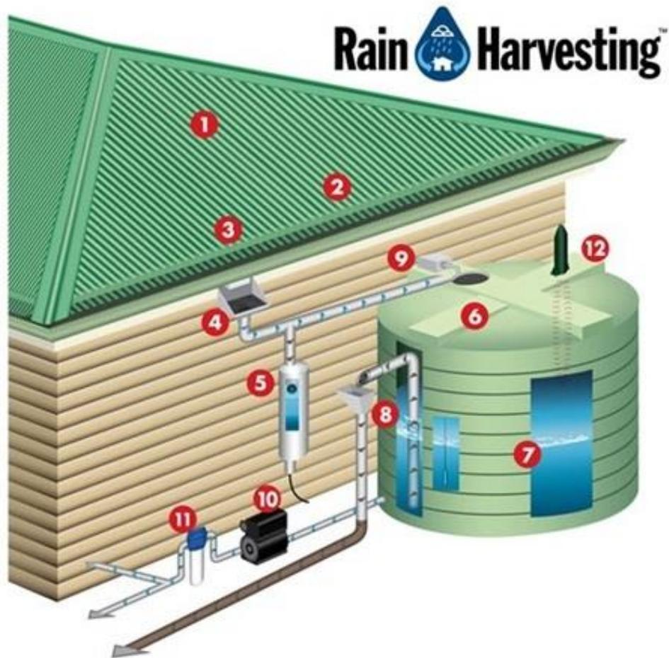
Gambar 2.5: Komponen bagian-bagian pemanen air hujan
