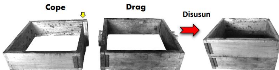
Gambar 2.1. Rangka Cetak persegi dari kayu
