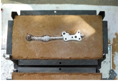
Gambar 4.8. Hasil Pengecoran sebelum di keluarkan dari cetakan
