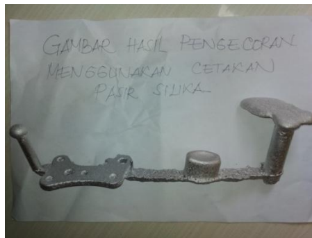
Gambar 4.9. Hasil Cetakan dan Hasil Produk Pasir Silika ( Dudukan Caliper Rem Sepeda Motor )
