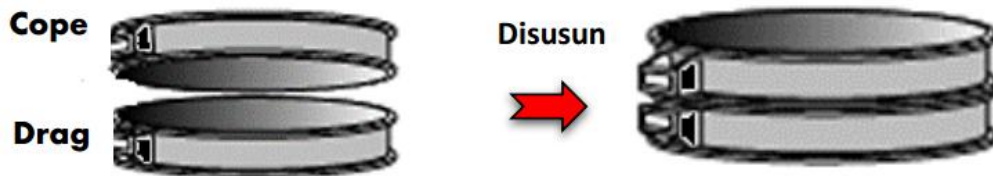
Gambar 2.3. Rangka Cetak bentuk silinder dari plat besi (Sudjana, 2008)
