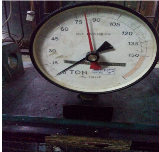
Gambar L11: Uji kuat tekan beton dengan campuran limbah pecahan beton 25% 28 hari: 82,5 T
