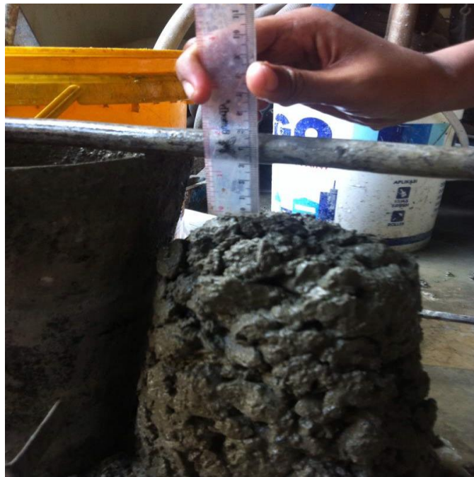
Gambar L6: Hasil pengujian slump test .
