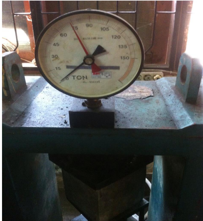
Gambar L9: Uji kuat tekan beton normal 28 hari: 75 T.
