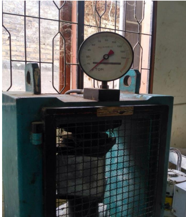
Gambar L7: Beton sebelum diuji kuat tekan.
