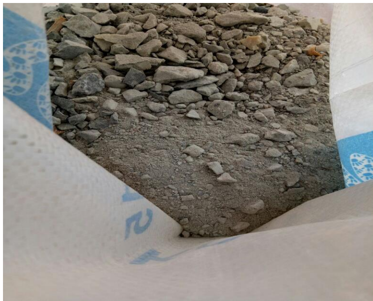
Gambar L4: Limbah pecahan beton..
