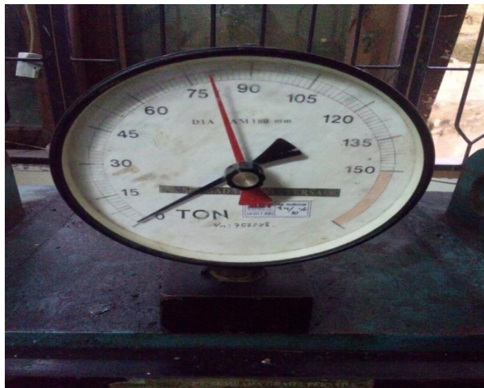
Gambar L10: Uji kuat tekan beton dengan campuran limbah pecahan beton 20% 28 hari: 81 T
