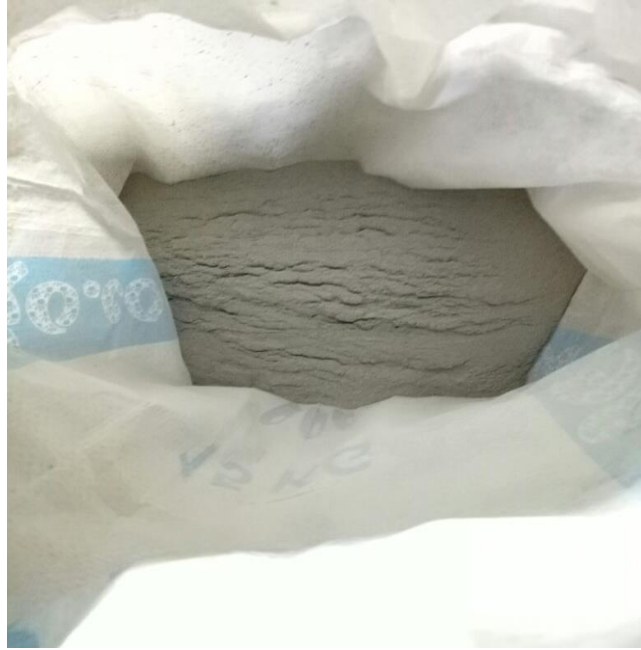
Gambar L5: Limbah pecahan beton yang tertahan disaringan No.100.
