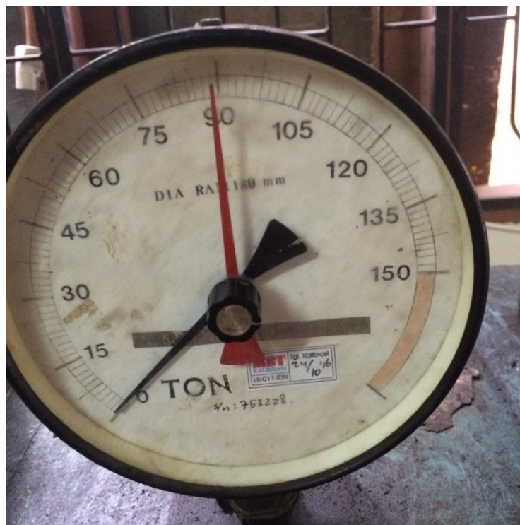
Gambar L12: Uji kuat tekan beton campuran limbah gipsum 14% 28 hari: 88,5 Ton.
