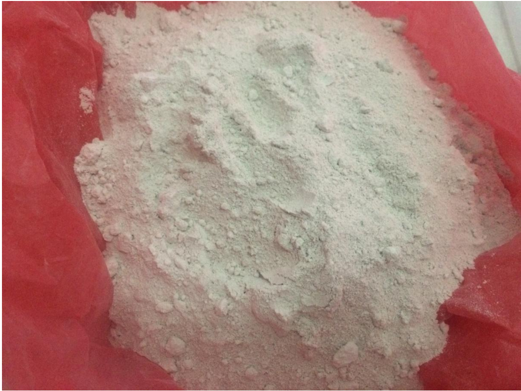
Gambar L5: Limbah gipsum yang sudah melewati proses penumbukan.
