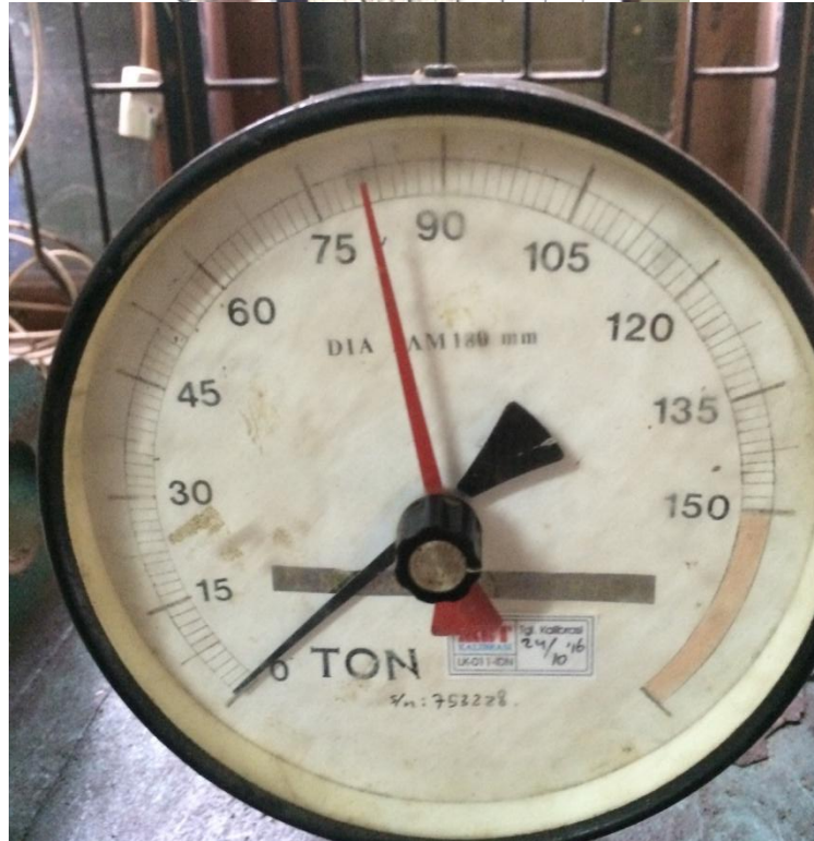
Gambar L11: Uji kuat tekan beton normal 28 hari: 81 T.
