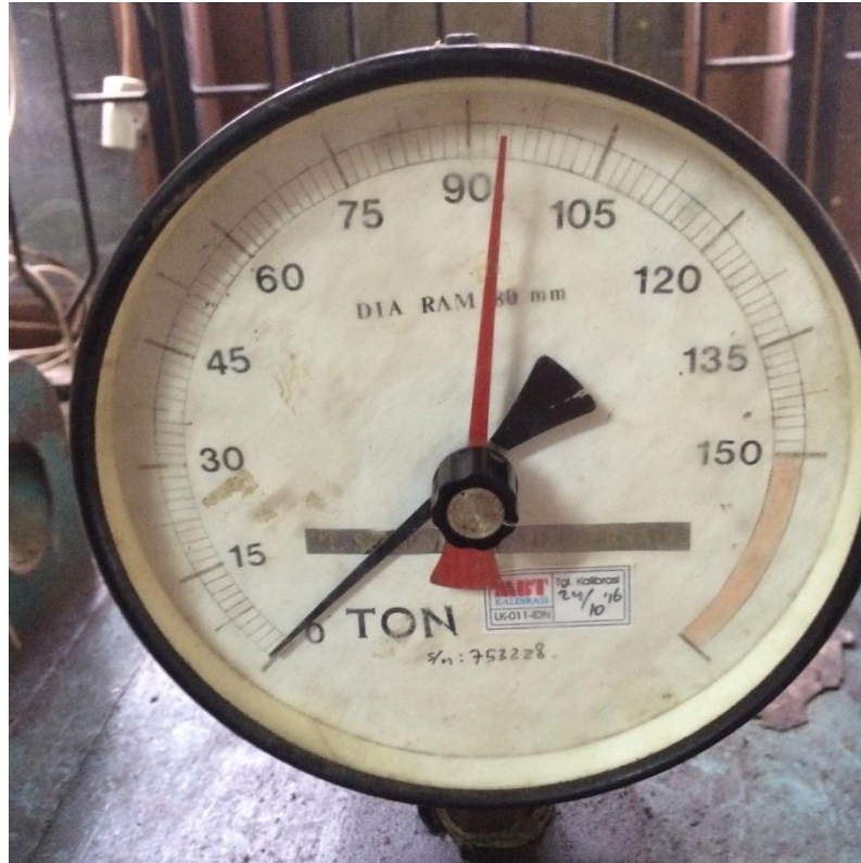
Gambar L13: Uji kuat tekan beton campuran limbah gipsum 17% 28 hari: 93,75 Ton.
