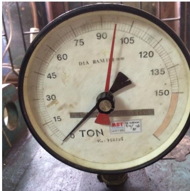
Gambar L14: Uji kuat tekan beton campuran limbah gipsum 20% 28 hari: 97,5 Ton.
