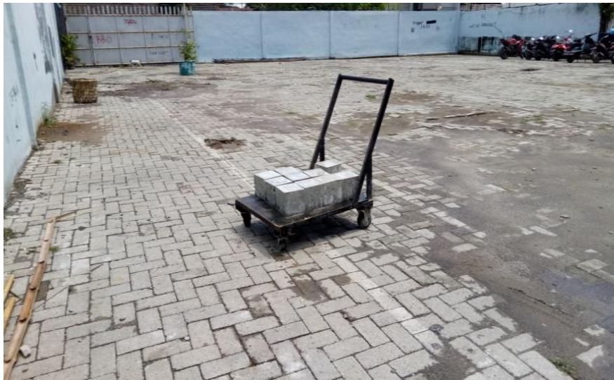
Gambar L8: Benda uji yang sedang dijemur.
