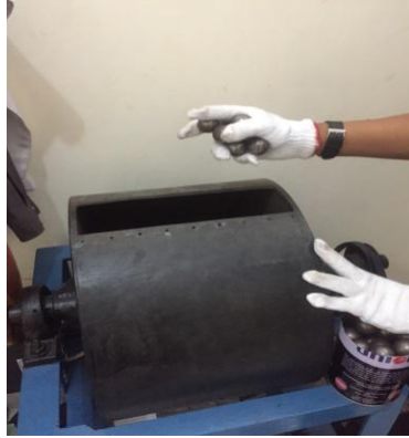
Gambar 4.18 Proses memasukkan bola baja kedalam tabung
