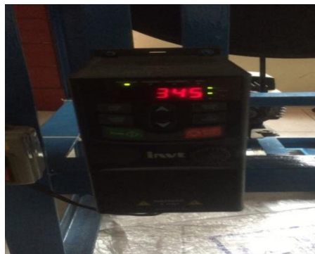
Gambar 4.120 Motor berputar selama 2 jam dengan kecepatan 345 rpm
