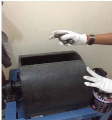
Gambar 4.32 Proses memasukkan bola baja kedalam tabung
