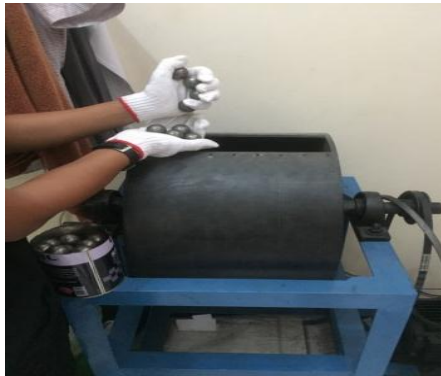
Gambar 4.4 Memasukkan bola baja ke dalam tabung
