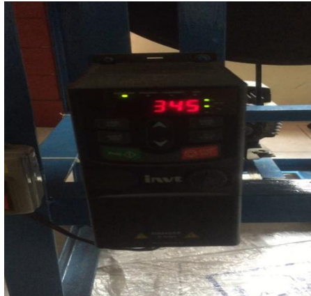
Gambar 4.6 Motor berputar selama 1 jam dengan kecepatan 345 rpm
