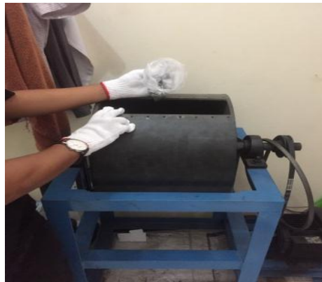
Gambar 4.31 Proses memasukkan material aluminium kedalam tabung.
