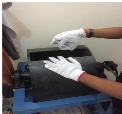
Gambar 4.17 Proses memasukkan material aluminium kedalam tabung.
