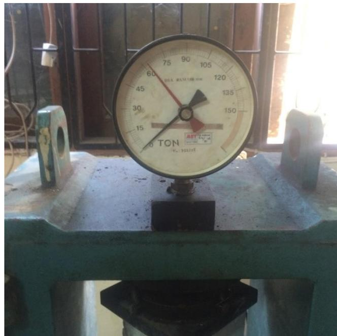
Gambar L16: Uji kuat tekan beton normal agregat halus Patumbak 14 hari 63 T.
