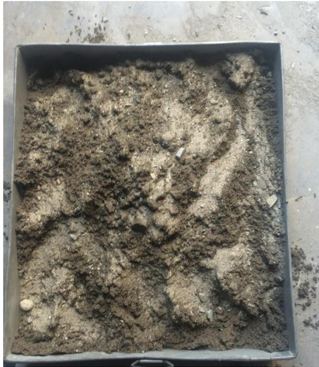
Gambar L5: Material agregat halus Sunggal yang akan digunakan.
