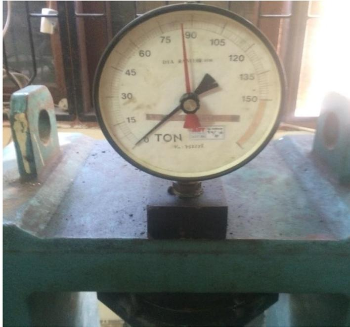
Gambar L17: Uji kuat tekan beton normal agregat halus Patumbak 29 hari 82 T.
