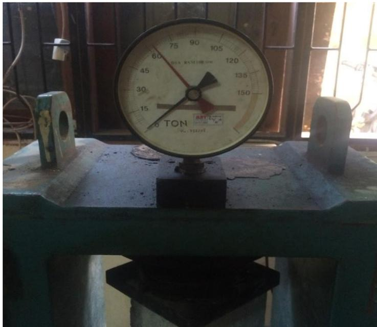
Gambar L14: Uji kuat tekan beton normal agregat halus Langkat 14 hari 63 T.
