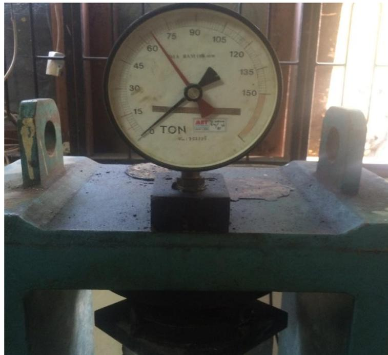
Gambar L12: Uji kuat tekan beton normal agregat halus Binjai 14 hari 65 T.
