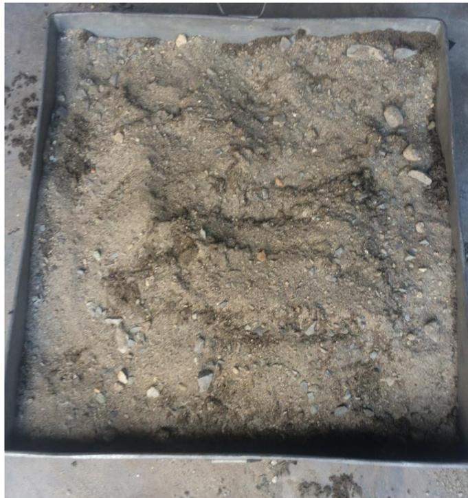
Gambar L4: Material agregat halus Patumbak yang akan digunakan.
