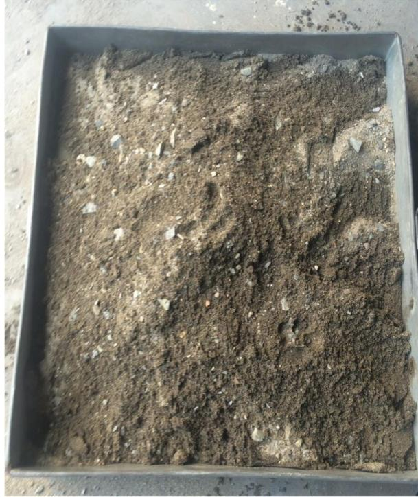
Gambar L3: Material agregat halus Langkat yang akan digunakan.
