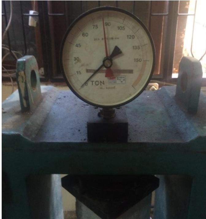
Gambar L15: Uji kuat tekan beton normal agregat halus Langkat 28 hari 82 T.
