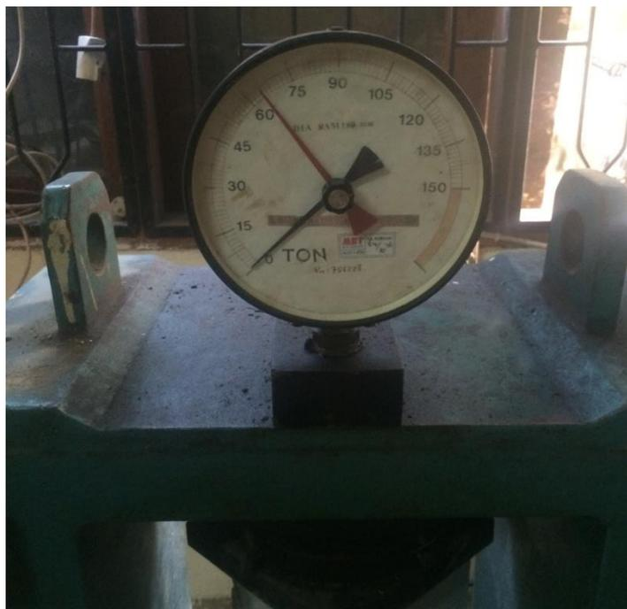
Gambar L18: Uji kuat tekan beton normal agregat halus Sunggal 14 hari 63 T.
