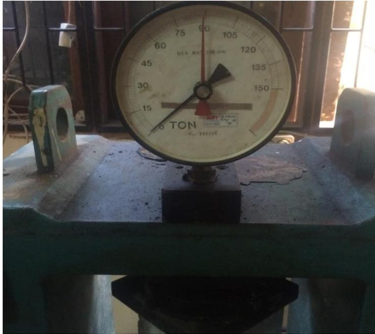
Gambar L13: Uji kuat tekan beton normal agregat halus Binjai 28 hari 89 T.
