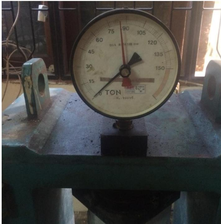
Gambar L19: Uji kuat tekan beton normal agregat halus Sunggal 28 hari 82 T.
