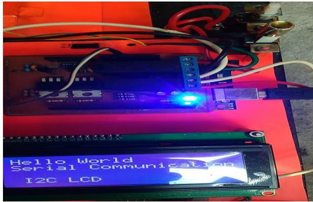
Gambar 4.3 Hasil pengujian LCD
