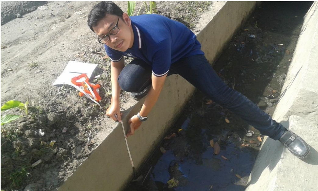
Gambar L.3: Pengukuran saluran kiri dan kanan.
