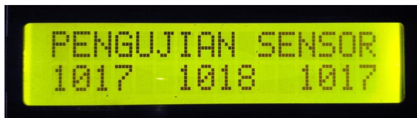
Gambar 4.7 Tampilan LCD Data Sensor Arus Tanpa Dilalui Beban
