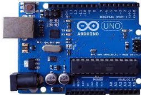
Gambar 2.5. Board Arduino ( Sumber: Yuwono Martha Dinata ; 2015 : 3 )
