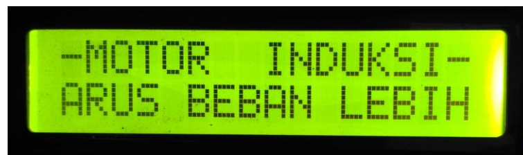
Gambar 4.16 Tampilan LCD Ketika Sensor Arus Mendeteksi Arus Lebih
