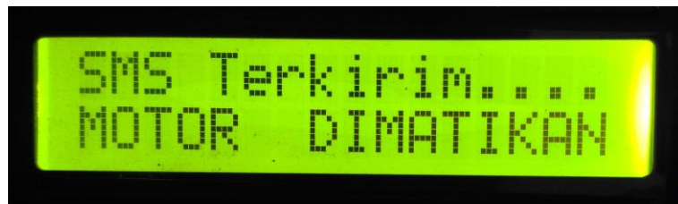
Gambar 4.18 Tampilan LCD Ketika Proses Pengiriman SMS Tel ah Dilakukan dan Motor Induksi Sudah Dimatikan
