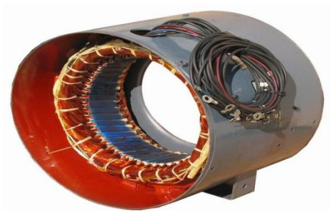
Gambar 2.6 Stator Generator Sinkron Sumber : Makalah Teknik Listrik Dan Elektronika
