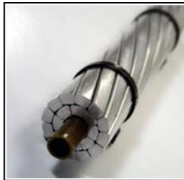
Gambar 2.6. Kawat konduktor tipe ACSR
