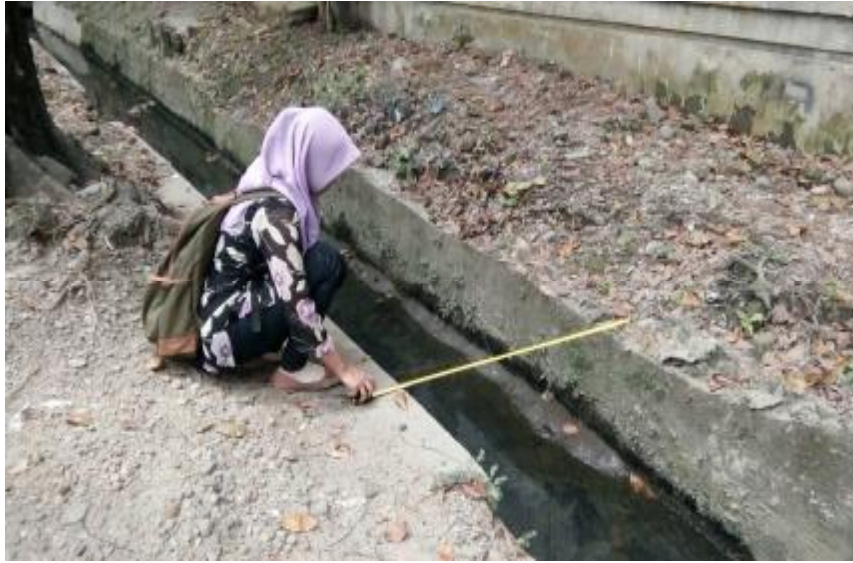
Gambar 3.7 Pengukuran dimensi penampang saluran drainase sebelah kiri di kawasan Jalan Jawa.
