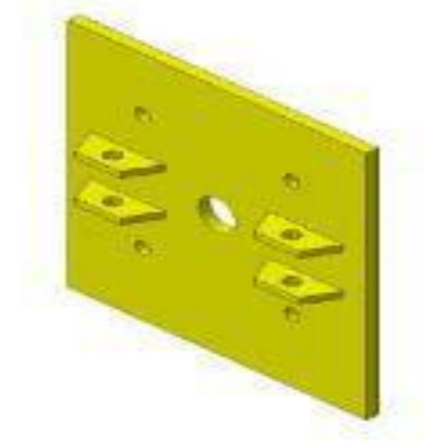
Gambar 4.6. Dudukan cetakan gerak
