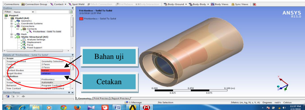
Gambar 3.14 Hubungan antara benda kerja dan cetakan
