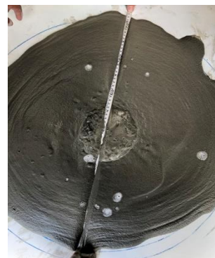
Gambar 3.29b Pengukuran Nilai Slump
