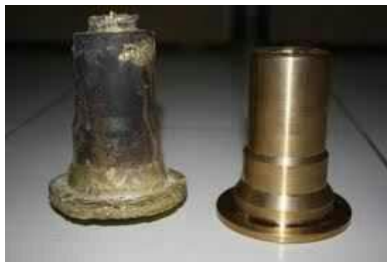
Gambar 2.6. Contoh produk cor yang cacat (Ceper, 2014)
