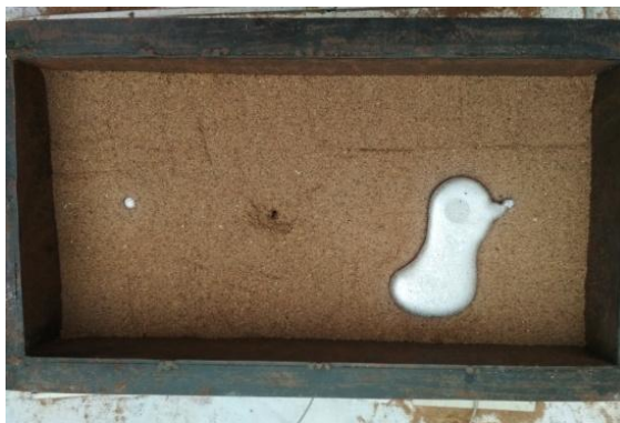
Gambar 4.22. Hasil Pengecoran dengan Menggunakan Pasir Pantai dari Atas
