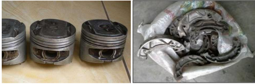
Gambar 2.3. Contoh Profil Aluminium Paduan (Piston dan Sepatu Rem)
