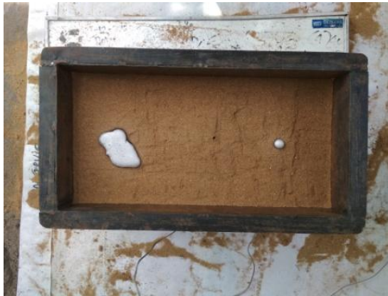
Gambar 4.16. Hasil Pengecoran dengan Menggunakan Pasir Silica dari Atas
