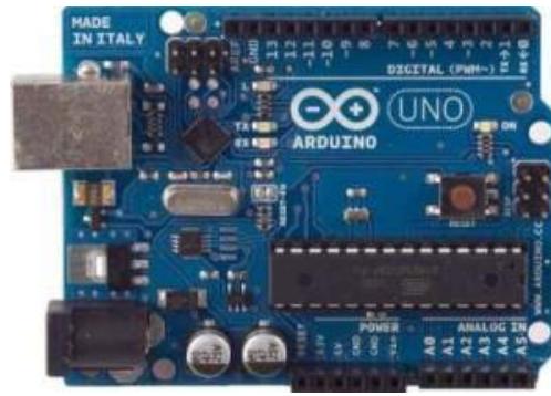
Gambar 2.8. Arduino UNO (iPanda, 2015)
