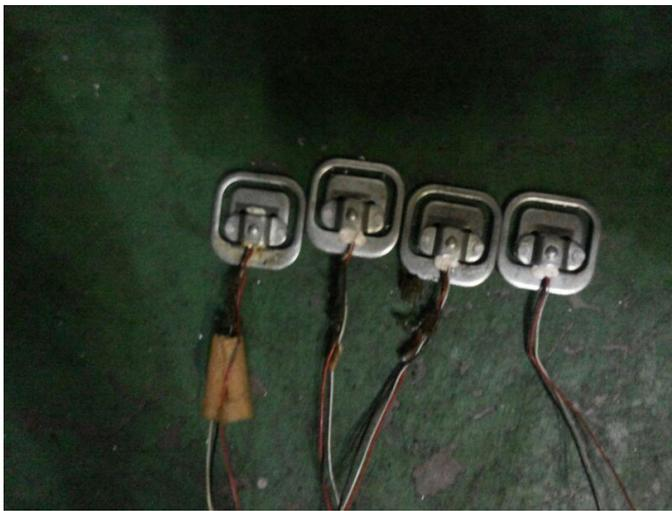
Gambar 4.1 rangkaian load cell
