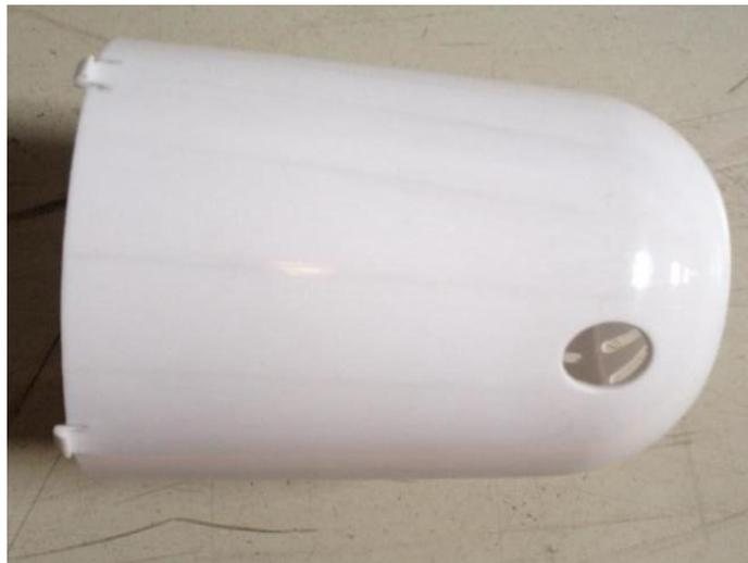
Gambar 2.14. Hasil produk cacat *weld mark or flow mark*
