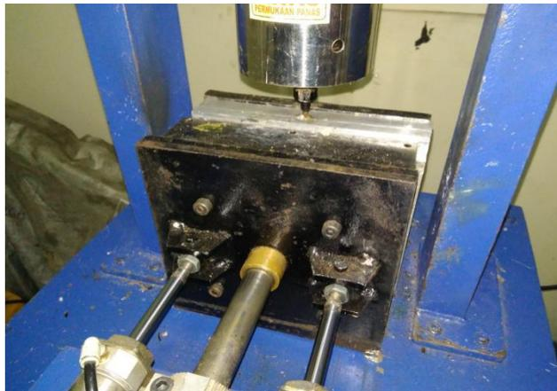
Gambar 3.20. Pengujian cetakan pada mesin cetak injeksi molding
