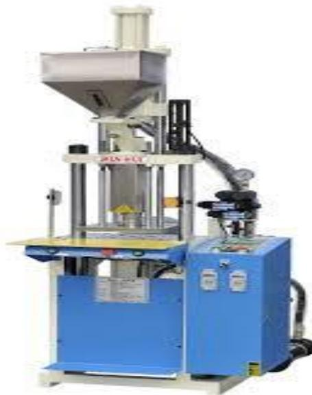
Gambar 2.2. Mesin cetak injeksi vertikal (Anwar Kholidi Nst, 2016)
