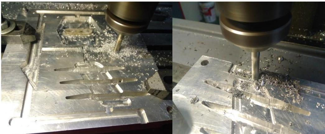
Gambar 3.19. Proses pembuatan alur masuk dan alur keluar
