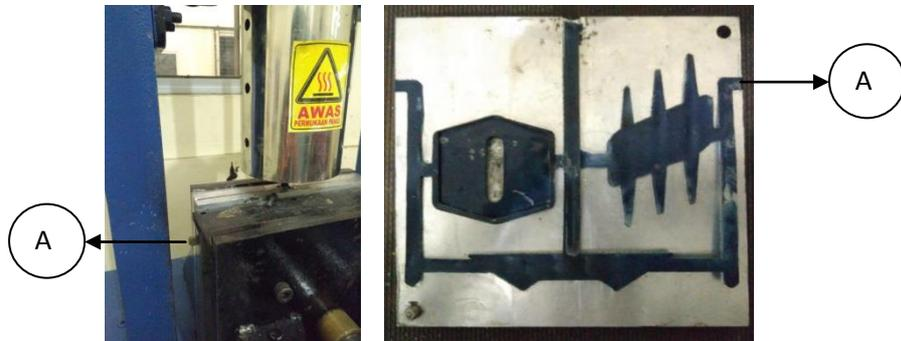
Gambar 3.21. Proses pengisian cetakan yang telah memenuhi *cavity* dan *core*
