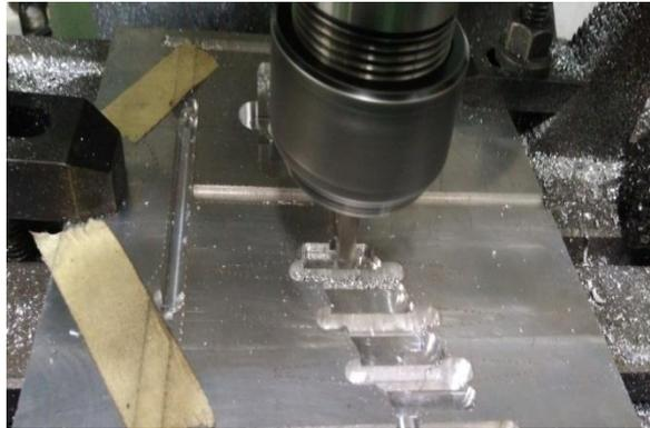
Gambar 3.18. Proses pembentukan cavity pertama aksesoris *door guard*
