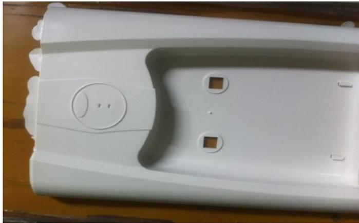
Gambar 2.12. Hasil produk cacat *flashing*
