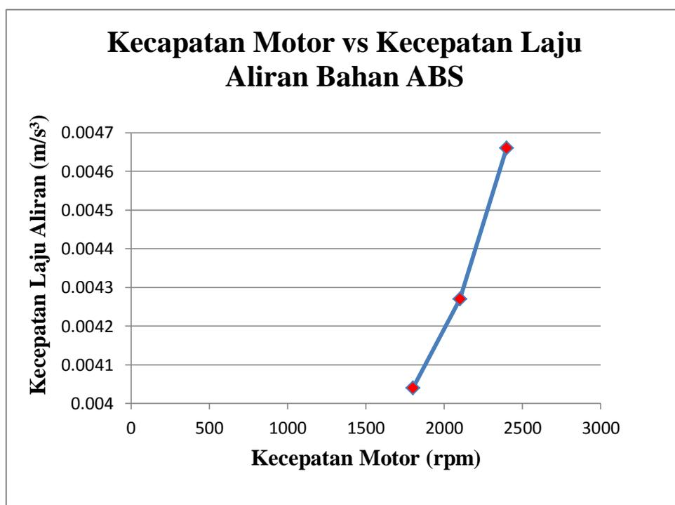
Gambar 4.9. Grafik perbandingan kecepatan motor dengan kecepatan laju aliran bahan ABS
