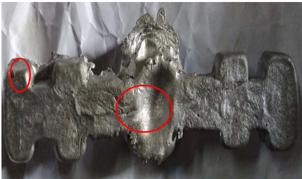
Gambar 4.1. hasil cetakan pada putaran 300 rpm dengan temperatur 500°C
