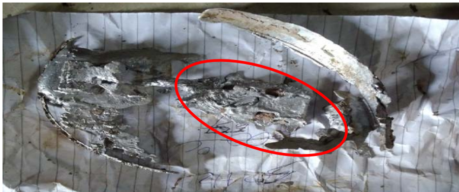
Gambar 4.3. Hasil cetakan sentrifugal pada putaran 1500 rpm dengan suhu 500 0 C.
