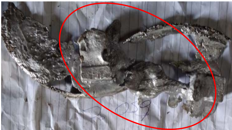
Gambar 4.2. Hasil cetakan pada putaran 900 rpm dengan suhu 500 0 C.
