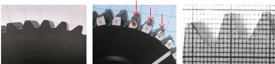
Gambar 4.6 komponen roda gigi sebelum aus (kiri) dan sesudah aus (kanan)
