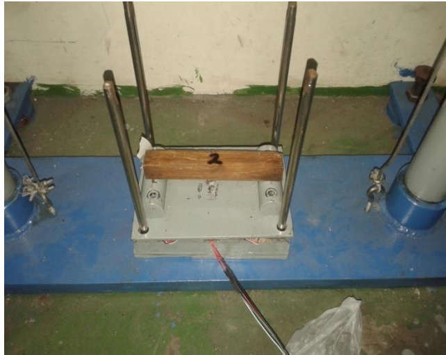
Gambar 3.19 Pengujian tekan dengan spesimen komposit dengan campuran serat yang bervariasi menggunakan dudukan spesimen.
