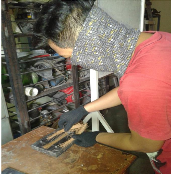
Gambar 3.16 Memasukan serat Kelapa
