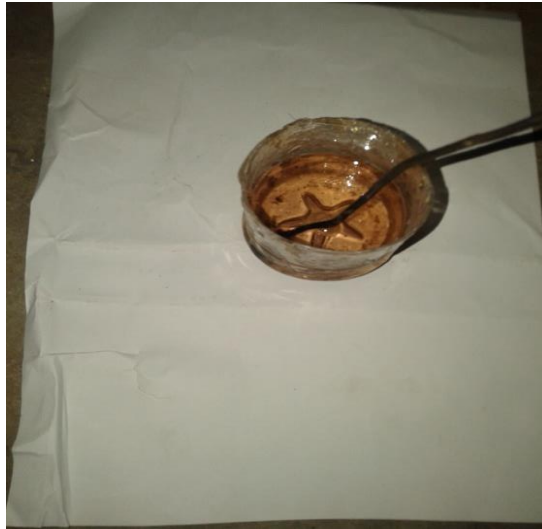
Gambar 3.15 Pencampuran resin dan katalis
