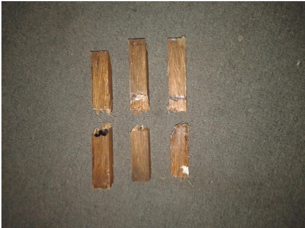
Gambar 4.10 Hasil Pengujian impact Gaya Jatuh Bebas Vertikal
