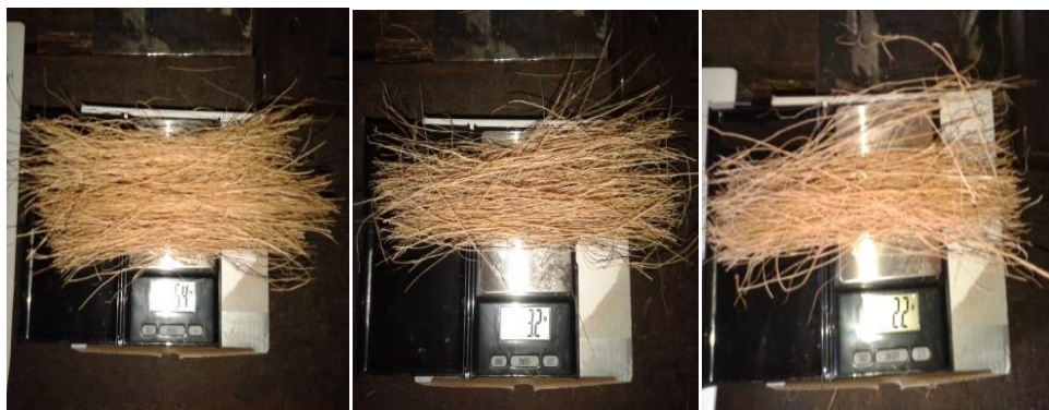
Gambar 3.12 Penimbangan serat kelapa
