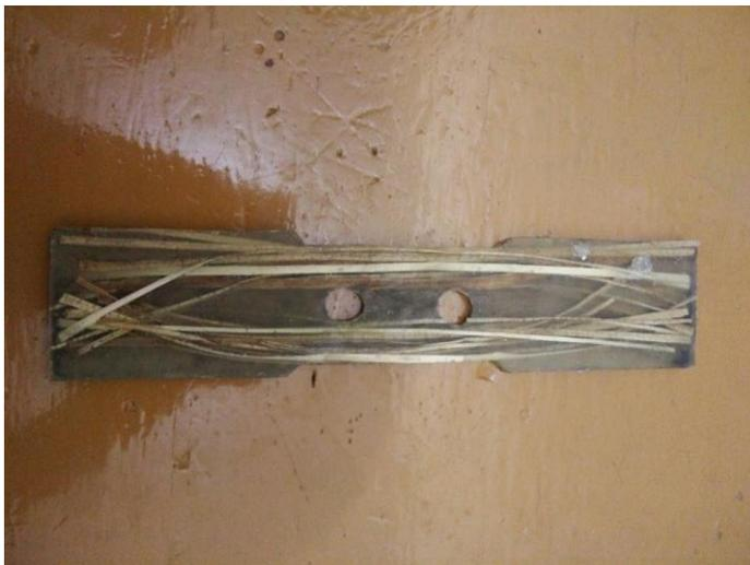
Gambar : 4.3 spesimen komposit sebelum diuji dengan diameter 14 mm.
