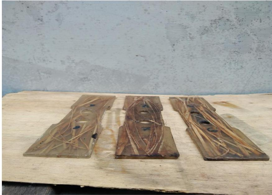
**Gambar 3.22 Proses Penjemuran Spesimen**
