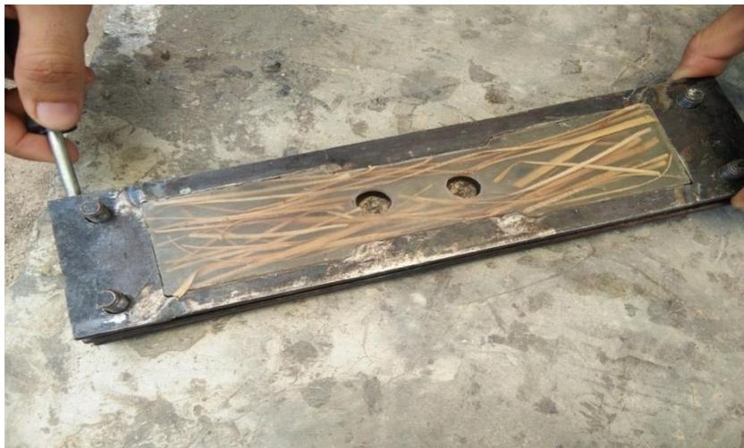
**Gambar 3.21 Proses pengeluaran spesimen dari cetakan**
