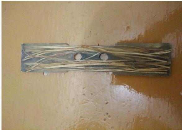
Gambar : 4.1 spesimen komposit sebelum diuji dengan diameter 12 mm.
