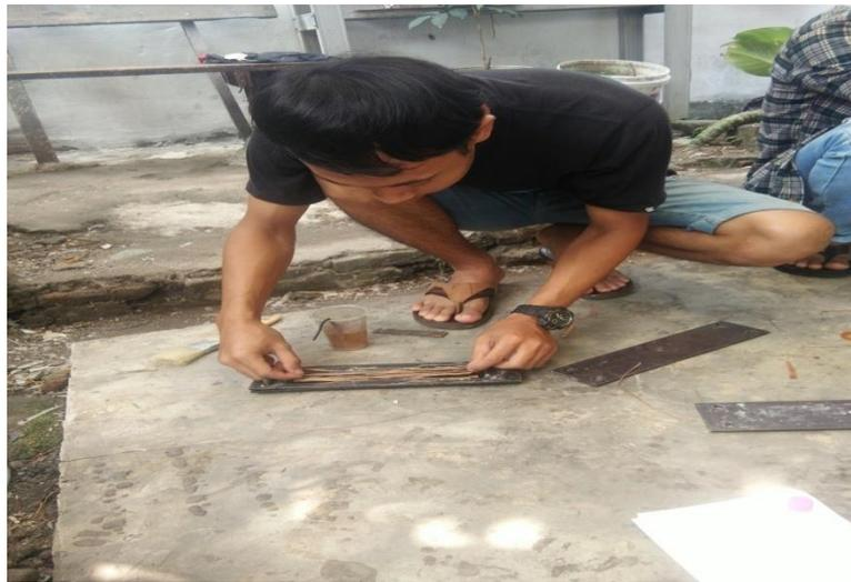
**Gambar 3.19 Penyusunan Serat**
