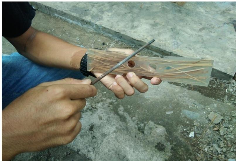
**Gambar 3.23 Pengikiran Spesimen**
