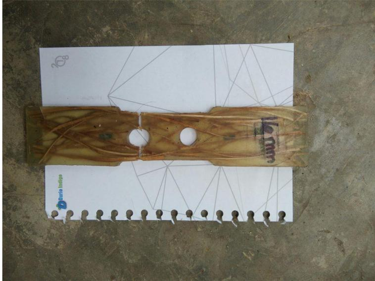
Gambar : 4.6 hasil pengujian tarik spesimen komposit diameter 16 mm
