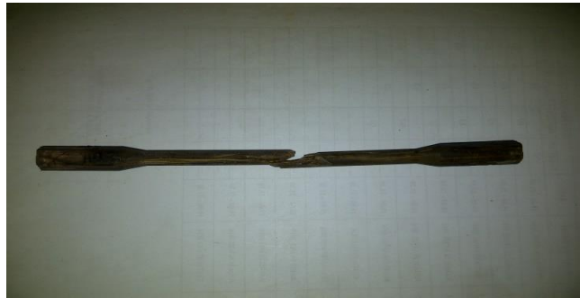
Gambar 4.3. Spesimen 1 komposit serat kayu dengan diameter 8 mm.
