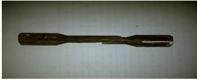
Gambar 4.8. Spesimen 6 komposit serat kayu dengan diameter 10 mm.
