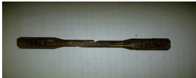
Gambar 4.7 Spesimen 5 komposit serat kayu dengan diameter 10 mm.
