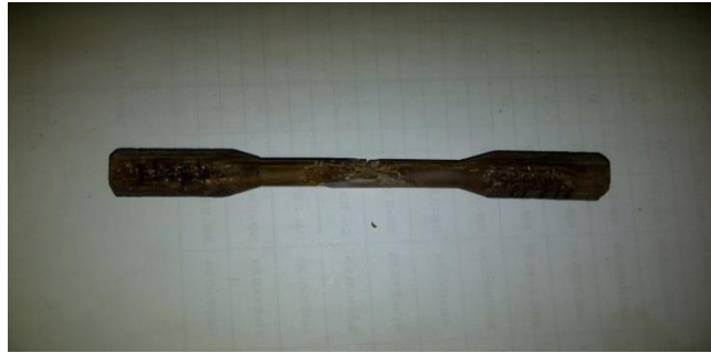
Gambar 4.6. Spesimen 4 komposit serat kayu dengan diameter 10 mm.
