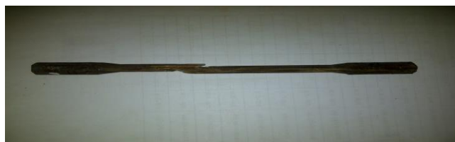
Gambar 4.5. Spesimen 3 komposit serat kayu dengan diameter 8 mm.
