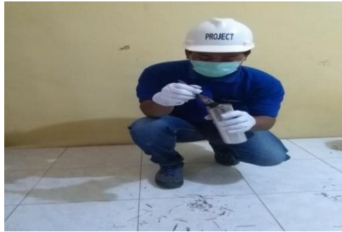
Gambar.3.20 Mengoleskan mirror glaze pada bagian cetakan spesimen.
