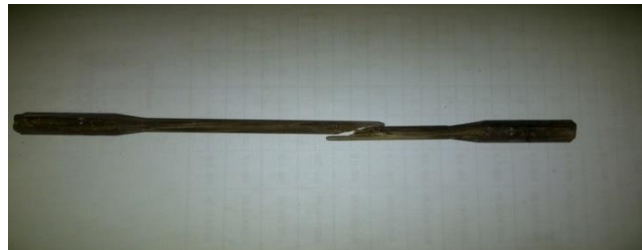
Gambar 4.4 Spesimen 2 komposit serat kayu dengan diameter 8 mm.
