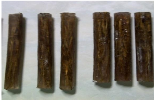
Gambar 3.25 spesimen sebelum dilakukan pembubutan.
