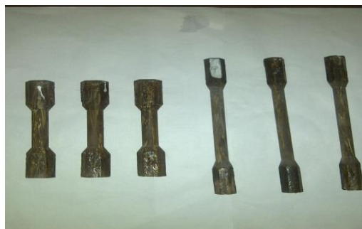
Gambar 3.36 spesimen sesudah dilakukan pembubutan.
