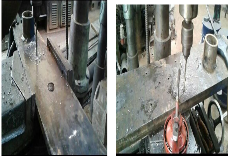
Gambar 4.5 Proses Pengeboran Menggunakan Mesin Milling
