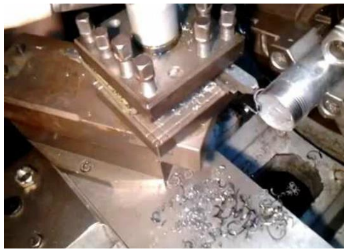
Gambar 4.3 Proses Pembuatan Derat Pada Pipa Steam
