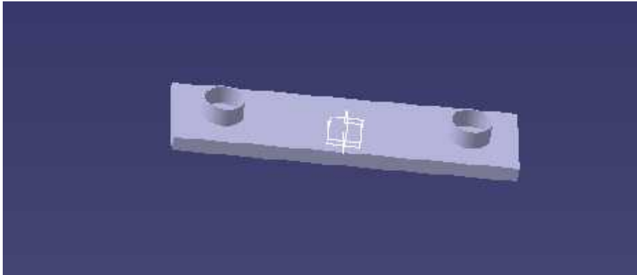
Gambar 4.3 Desain dudukan tiang dan meja spesimen
