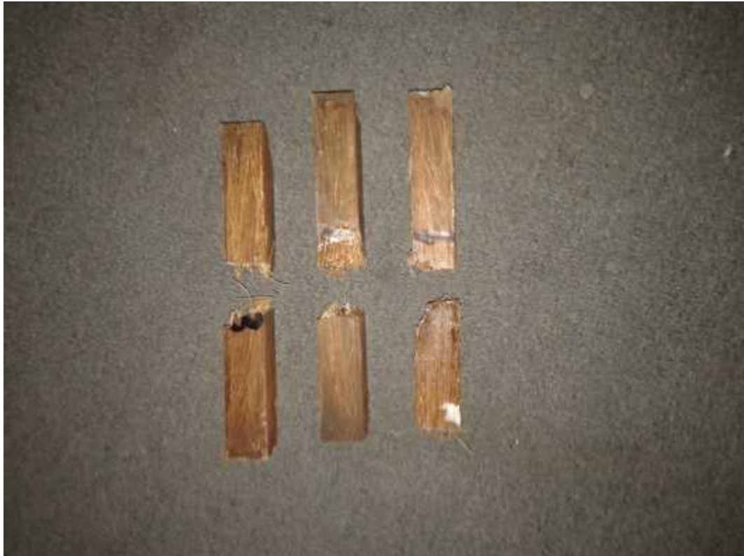
Gambar 4.14 Hasil Pengujian impact Gaya Jatuh Bebas Vertikal specimen komposit
