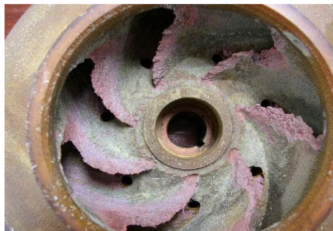
Gambar 2.7 Erosion Corrosion pada sebuah blade
