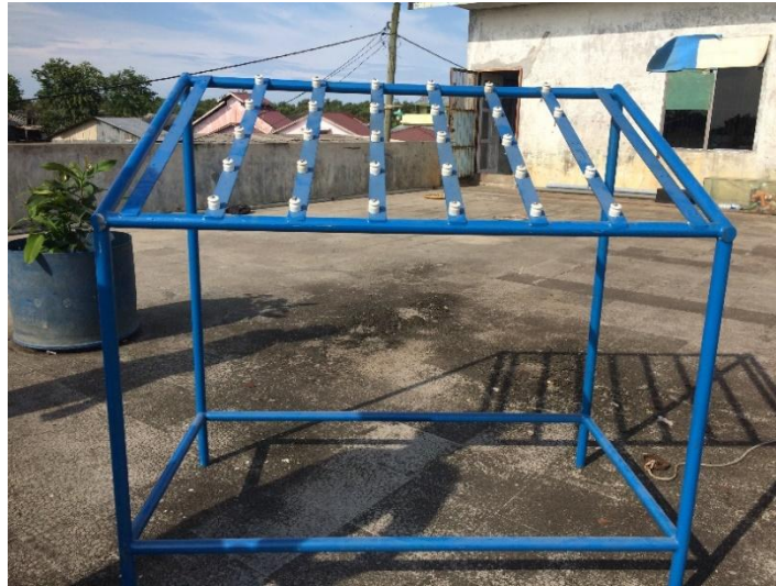
Gambar 3.9. Rak pengujian yang digunakan dalam penelitian korosi atmosferik
