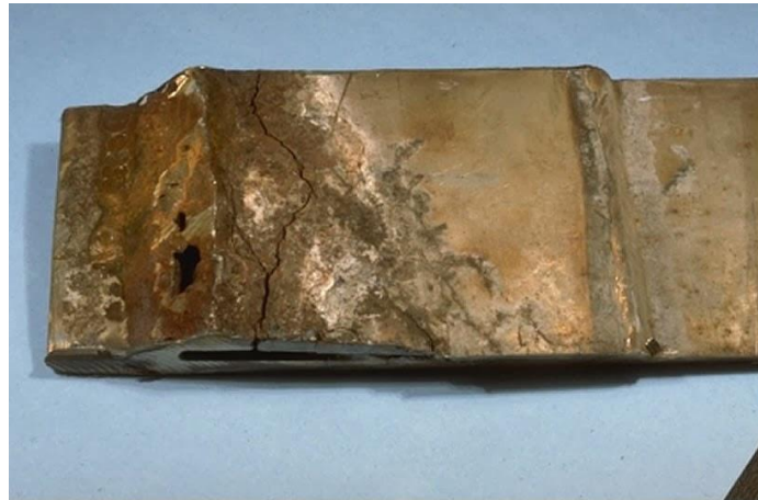
Gambar 2.6 Stress Corrosion Cracking pada logam
