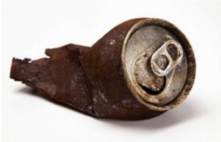
Gambar 2.1 Uniform Corrosion pada kaleng minuman
