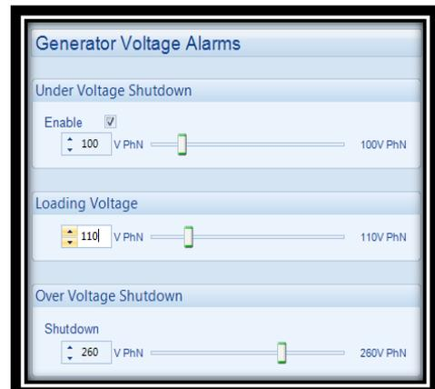
Gambar 3.5 Pengontrolan *Voltage* pada Modul Deep Sea Elektronik 3110
