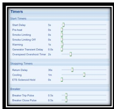
Gambar 3.4 Pengontrolan *Timers* pada Modul Deep Sea Elektronik 3110
