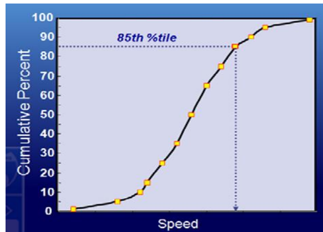
Gambar 2.7: Contoh grafik distribusi normal kecepatan persentil 85 (Knodler Jr & Collura, 2008).
